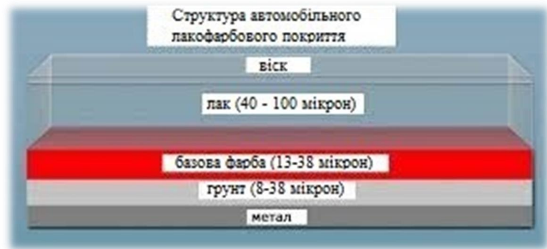
Рисунок 1 – Структура лакофарбового покриття
