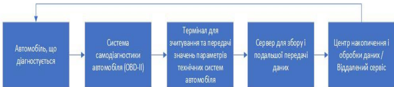
Рис. 4. Схема взаємодії елементів сервісу віддаленого контролю параметрів технічних систем транспортних засобів (за [6], трансформована)
